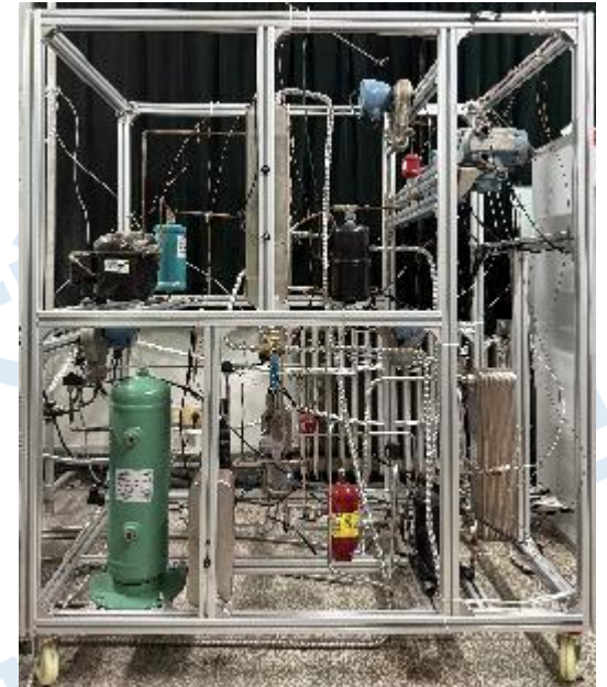
补气增焓+ 机械过冷系统 (V2.0)
